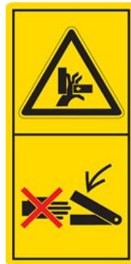
Restez en dehors de la zone de serrage lorsque la pièce est en mouvement.
