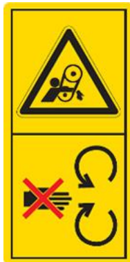
Ne pas retirer la protection lorsque la machine est en marche.
