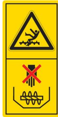
Ne mettez jamais les mains ou les pieds dans la trémie lorsque la machine est en marche.
