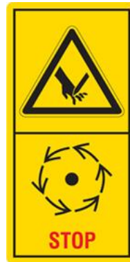
Ne touchez pas les pièces de la machine avant qu'elles ne soient complètement immobiles.
