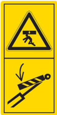
Le travail sur la machine n'est autorisé que lorsque le dispositif de sécurité du cylindre est en place.
